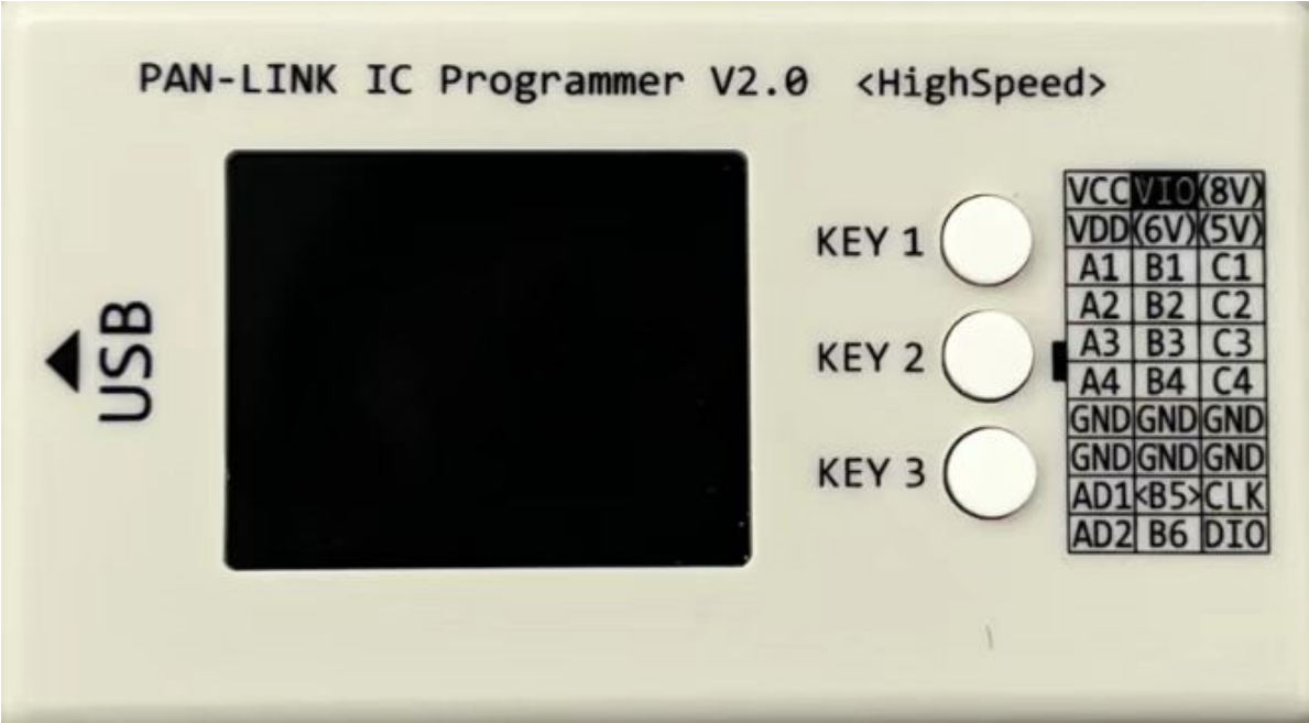
图2-1 PAN-LINK 烧录器
